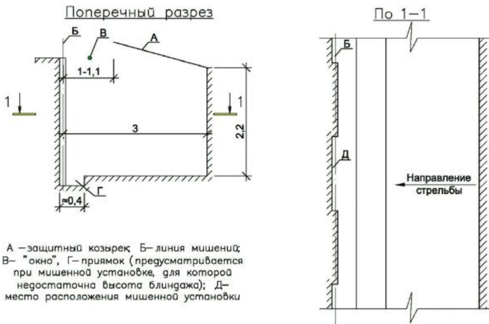
Рис. 2. Заглубленный блиндаж огневой зоны закрытого тира (размеры, м).
